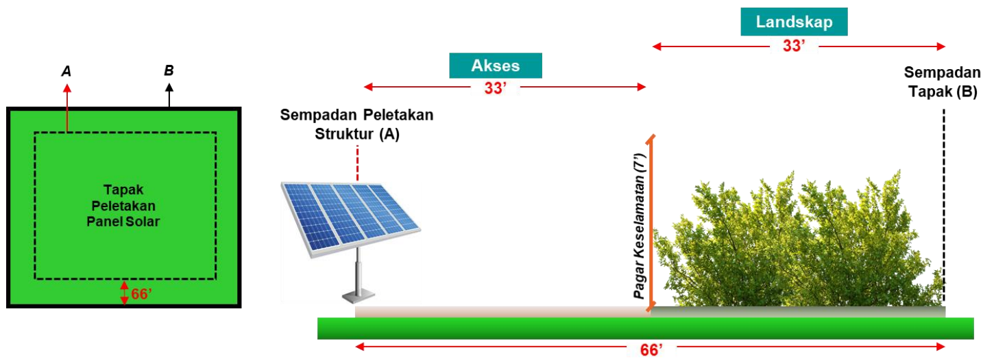
Rajah 2: Ilustrasi Anjakan Peletakan Struktur (Zon Neutralisasi)
